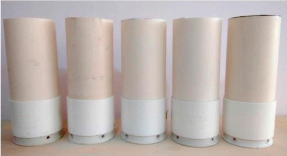
*Figura 3. Porómetros utilizados para la determinación de las propiedades físicas de los sustratos.*
