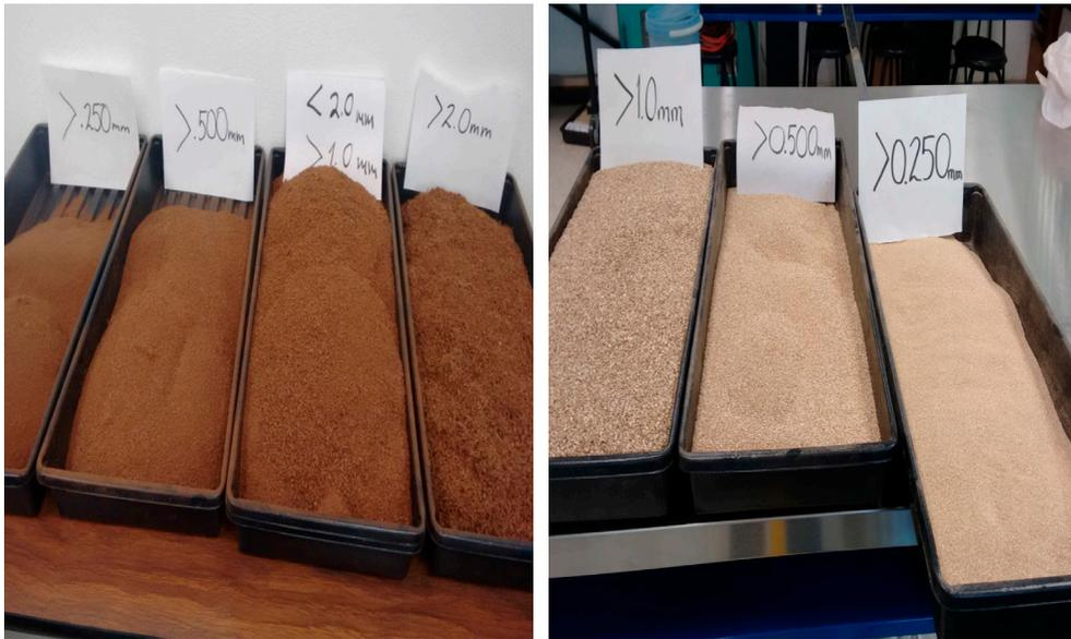
Figura 8. Fracciones granulométricas de polvo de coco y vermiculita, obtenidas por tamizado.
