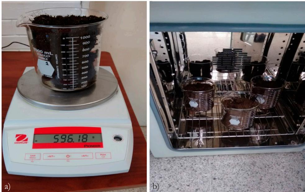
Figura 7. Determinación del peso húmedo (a) y peso seco (b) de la mezcla comercial Sunshine3®.
