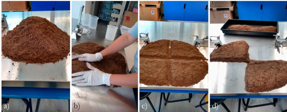
*Figura 4. Toma de muestra por el método del cuarteo. a) Sustrato seco listo para evaluar; b) Formación del disco; c) División del disco en cuatro partes; d) Eliminación de dos partes opuestas.*
