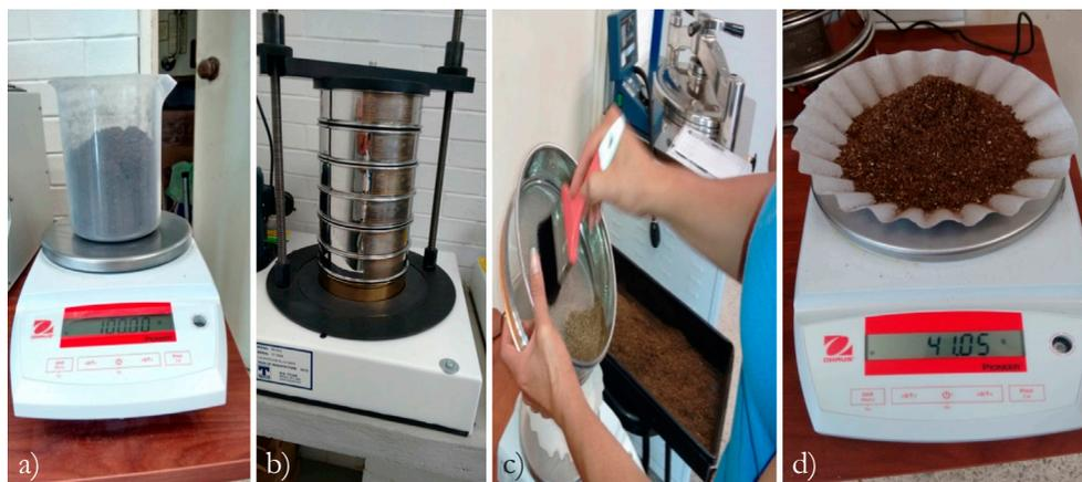
*Figura 2. Determinación granulométrica del sustrato. a) Obtención de 100 g de sustrato seco; b) Batería de tamices; c) Recolección del sustrato por tamiz; d) Determinación del peso del sustrato por tamiz.*
