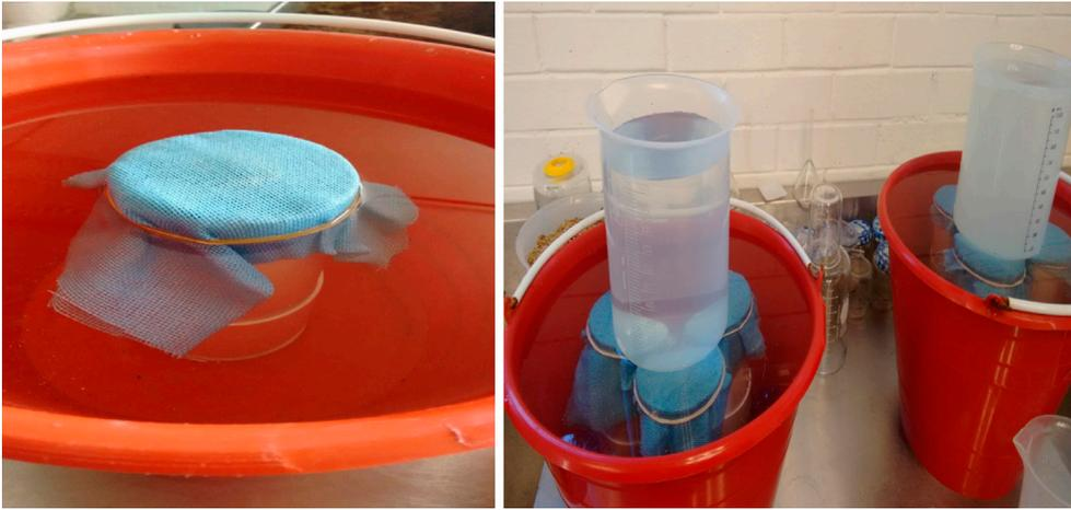
*Figura 6. Saturación del sustrato por 24 h. El nivel del agua no rebasa el borde superior de los porómetros.*
