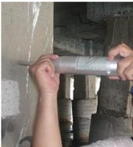
Figura 3. Muestra el ensayo de esclerometría
