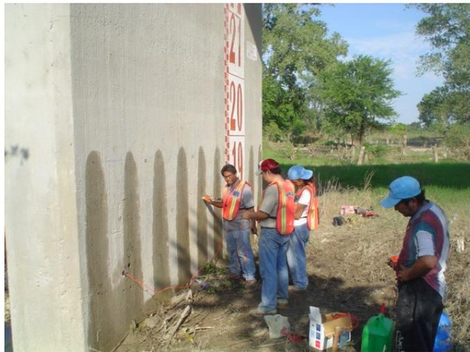
*Figura 7. Muestra la medición de potencial de corrosión*
