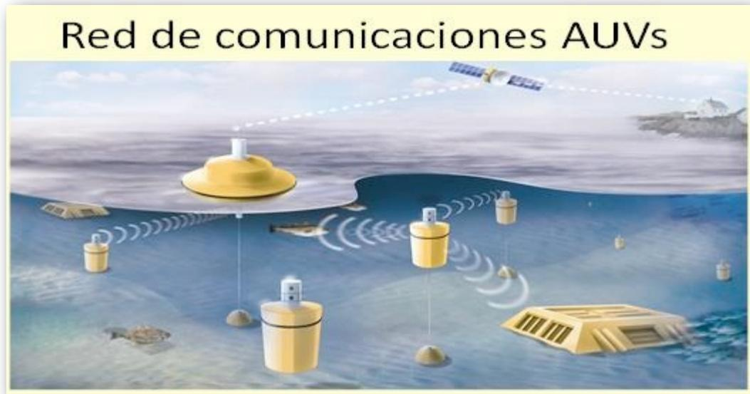
*Figura 41. Red de comunicaciones de vehículos y sensores submarinos AUVs (Imagen tomada de la Wikipedia)*
