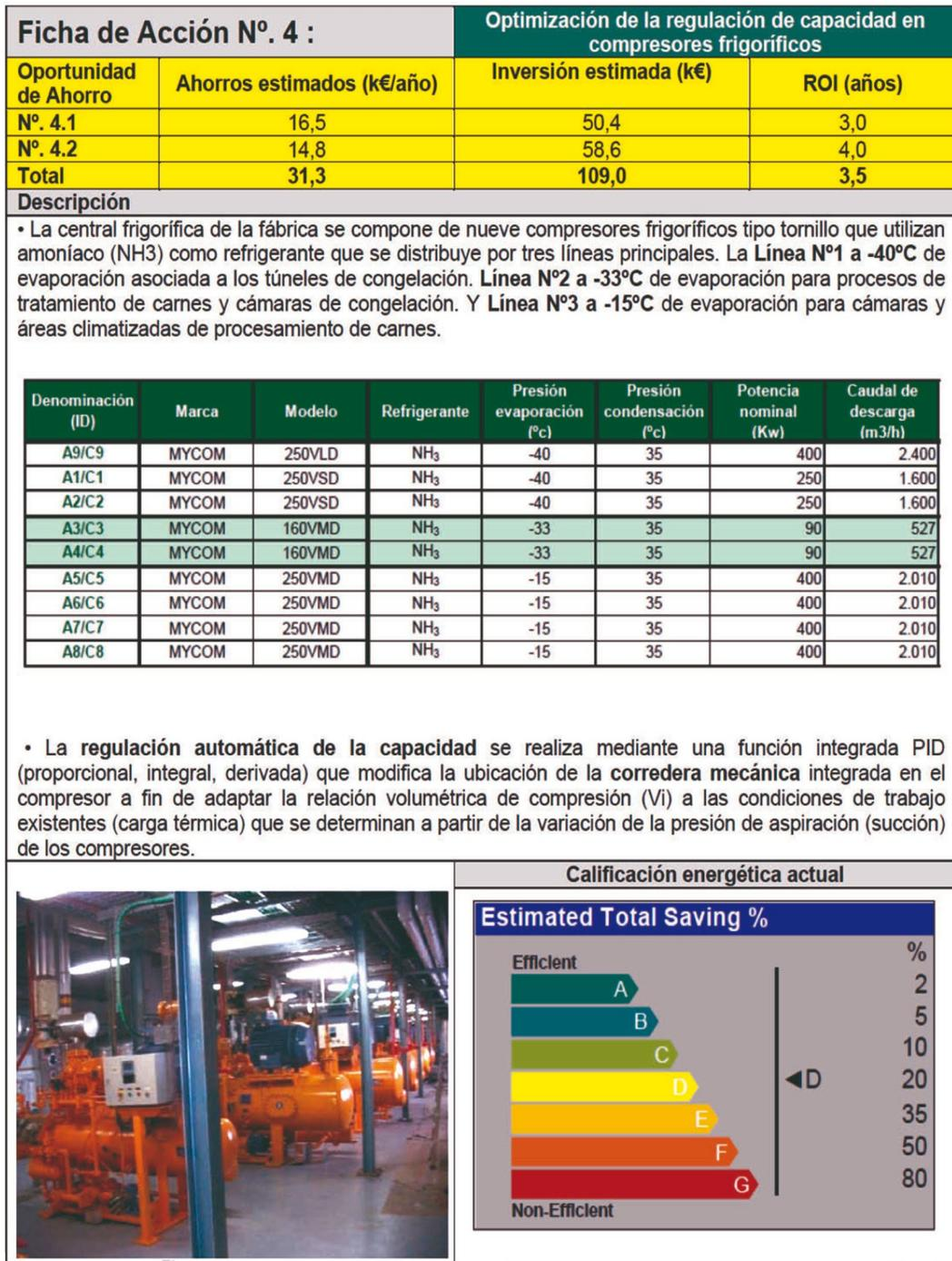
Figura 27. Ejemplo del detalle de una acción de eficiencia energética en el entorno de la refrigeración industrial. Fuente: elaboración propia
