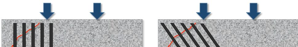
Figura 3.14: Laminados adheridos para refuerzo de cortante.
