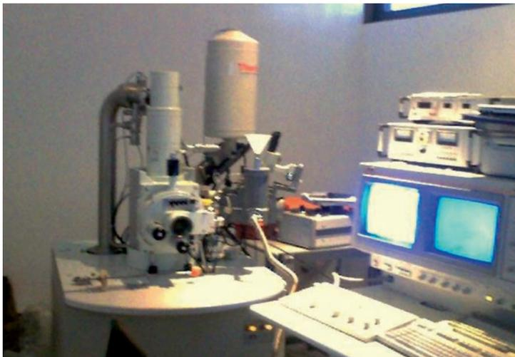
Figura 5.5. Equipo de Microscopía Electrónica de Barrido JEOL 6300.
