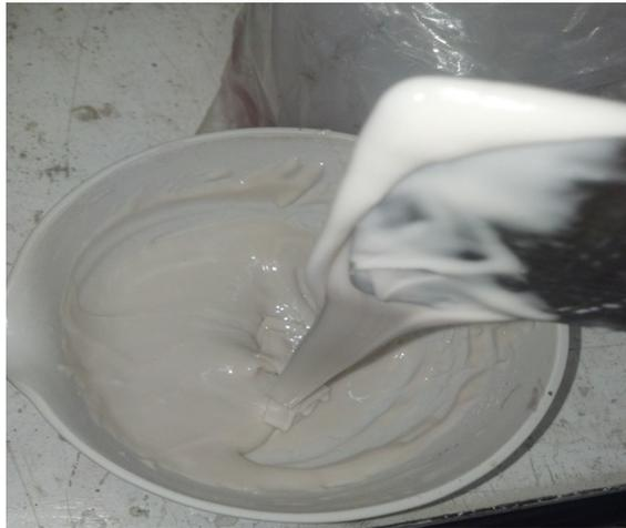
*Figura 3. Mortero Realizado con Resina y Calcita*
