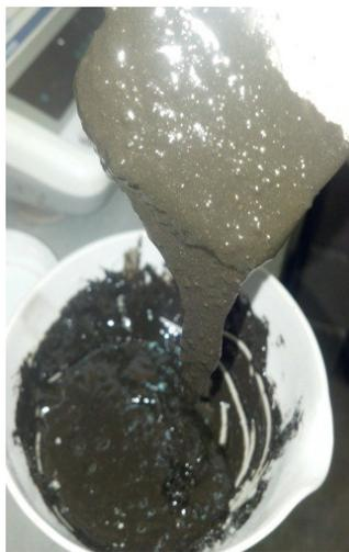
Figura 6. Mortero Realizado con Resina y Arcilla Húmeda
