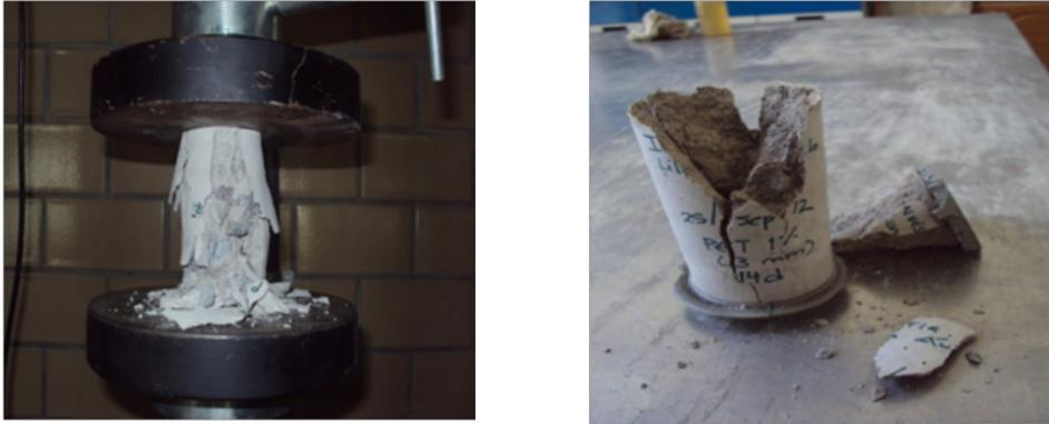
Figura 7. Prueba de resistencia a la compresión
