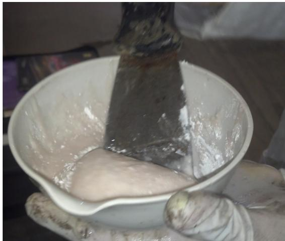
*Figura 2. Mortero Realizado con Resina y Cal*
