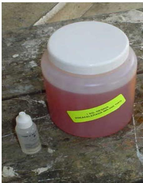
*Figura 1. Resina Utilizada para la elaboración del Mortero-Reparador*
