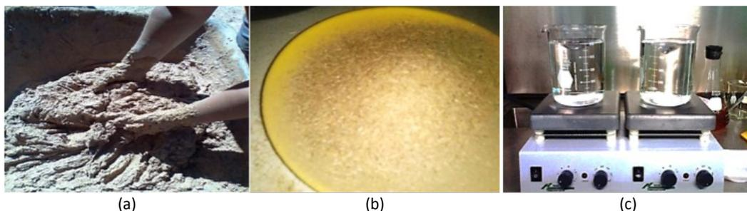
Figura 4. Preparación de materiales. (a) Moldeo del barro, (b) fibra molida, (c) poliestireno expandido diluido
