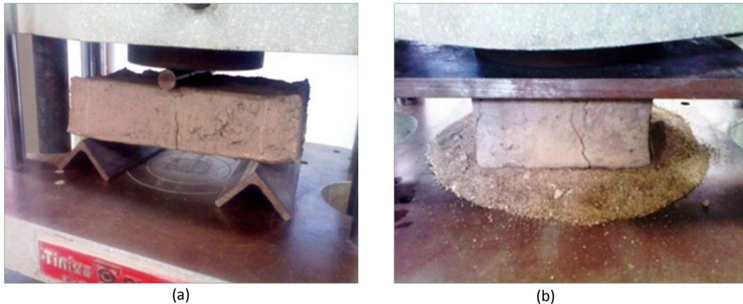
Figura 13. Ensayos mecánicos. (a) Fractura resultante en un adobe bajo la prueba de flexión y (b) fractura resultante en un adobe bajo la prueba de compresión
