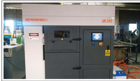
**Figura 6.9:** Sistema automatizado para impresión en 3D con láser.
