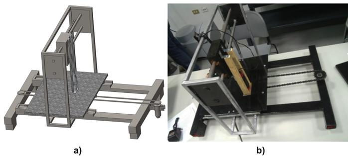
**Figura 5.29:** Prototipo de un robot cartesiano de tres grado de libertad, a) diseño mecánico y b) prototipo real.
