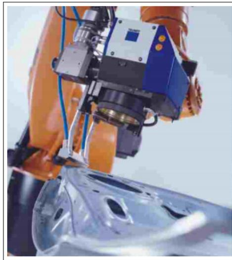
**Figura 6.11:** Soldadura con láser mediante robot KUKA.
