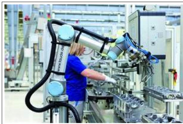
**Figura 1.8:** Robot instalado para montaje de bujías de incandescencia (*glow plugs*) en proceso de ensamble de cabezas de cilindros [13].
