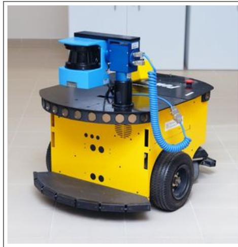
**Figura 6.13:** Robot móvil con sistema de navegación con láser.
